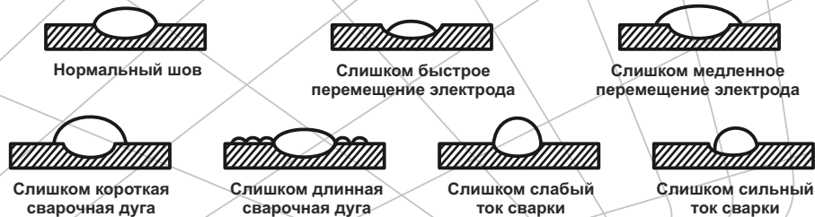
Рисунок 6. Основные виды ошибок при сварке полуавтоматом.
